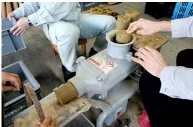
土練機を用いた粘土の調整作業
