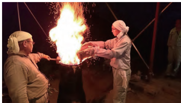
写真4 操業実験で炭を投入している状況
