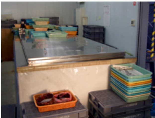
ポリエチレングリコールの樹脂含浸槽 60~100%の濃度の含浸を行います Polyethylene glycol impregnation tank Impregnates at 60~100% concentration
