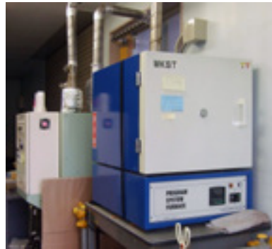
出土品にしみこんだプラスチックを揮発させるための電気炉
