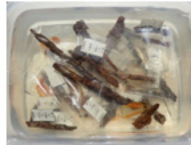
純水に漬けて脱塩している様子 Desalting in pure water
