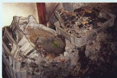
火災で融けたコンテナ
