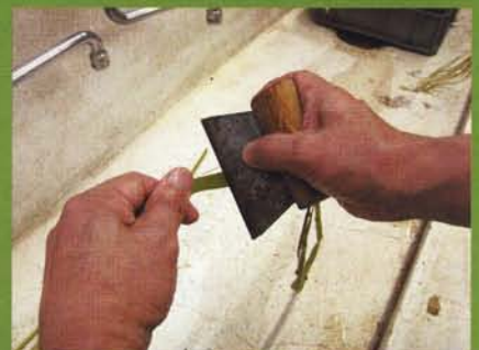
剥ぎ取った皮の裏側に苧引き具を当てて、表の皮を剥ぎ取ります。この細かいテクニックは企業秘密。
